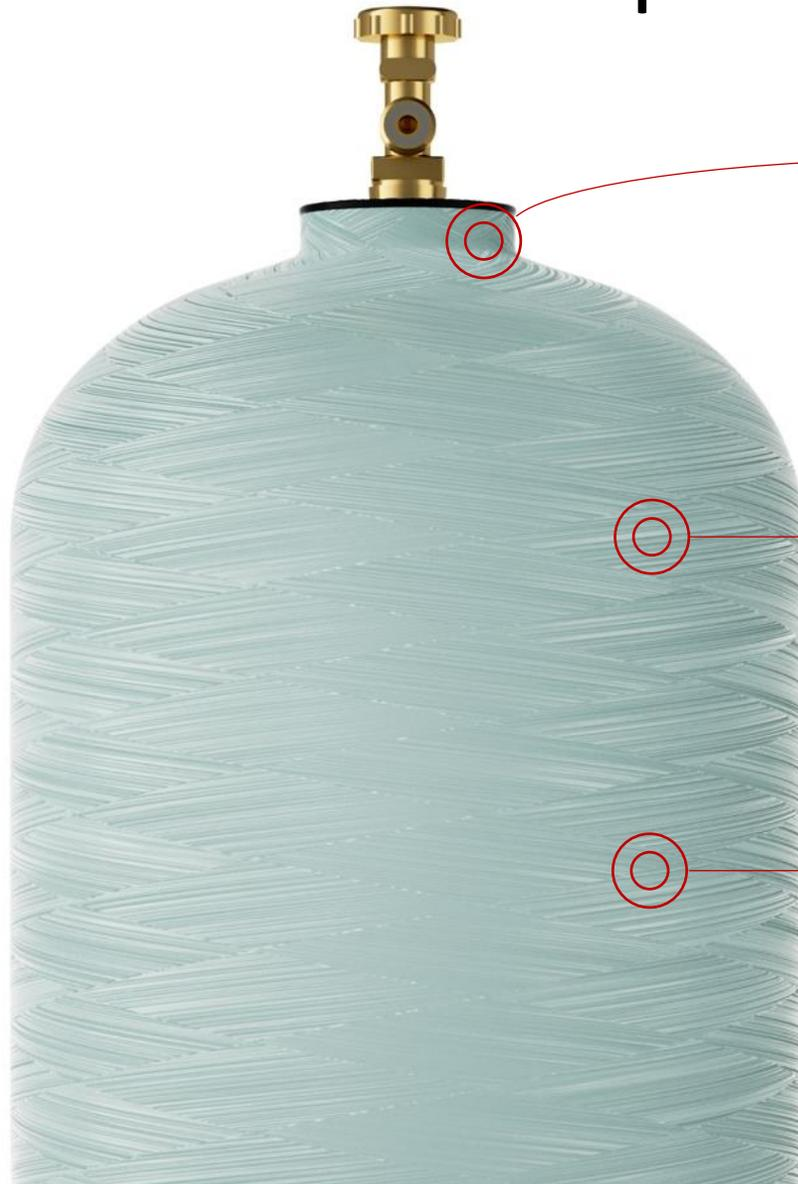
Горло баллона. Стандартная резьба 25E согласно ISO 11363-1:2010. Баллон может быть изготовлен с любой другой резьбой. Максимально допустимый момент затяжки при установке вентиля 200 Nm.
